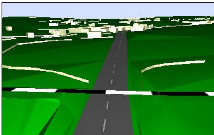
**Figura 5 – Vista 3D de um cruzamento disnívelado entre a linha férrea e uma via rodoviária.**
