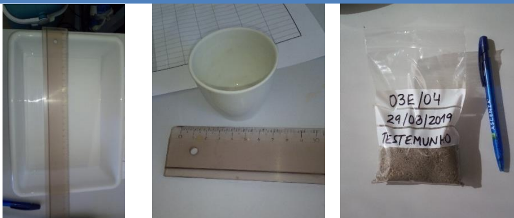
Figura 1 – Material de laboratório usado no processamento das amostras de sedimento. Tabuleiro de plástico usado na secagem; cadinho de Teflon para incinerar o sedimento; saco com amostra depois de seca.
